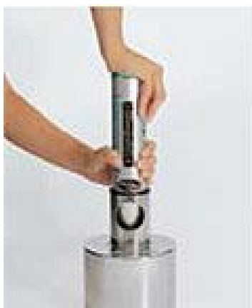
شکل 41- نحوه کالیبراسیون چکش اشمیت معمولی و شاقولی
