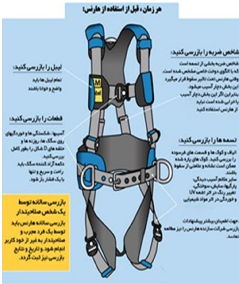
شکل 6: بررسی های مورد نیاز کمر بند هارنس
